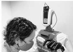
検温ロボット (THK株式会社製) 検温ロボットが発熱者を遠隔で検知。 発熱者は受付でブロックします。
